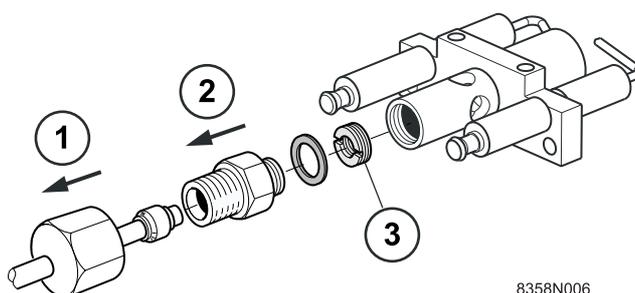
① Desmontar el tubo de alimentación de gas del quemador de encendido (llave del 13).
