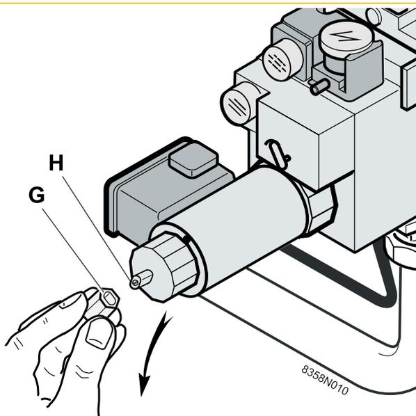
La progresividad viene ajustada de fábrica al valor mínimo (presión de arranque baja).
